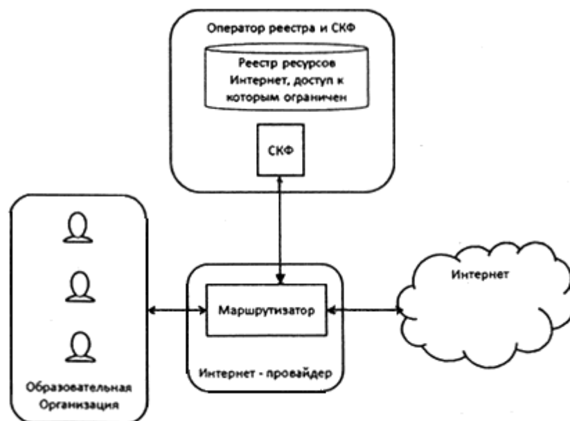
Рис.5. Схема работы контент-фильтрации при едином решении
